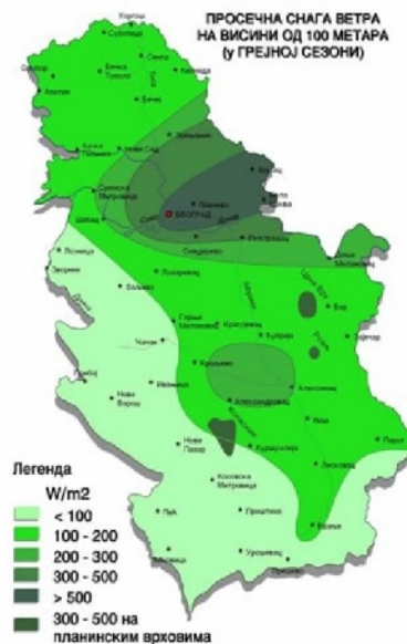
Слика бр.12: Просечна снага ветра на висини од 100 метара
